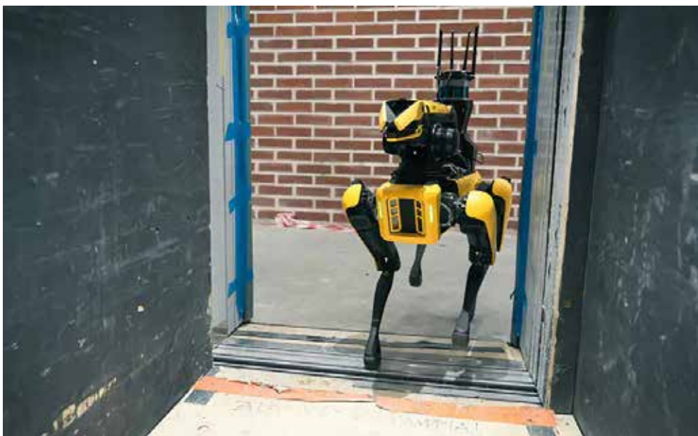
Spot je visokotehnoški štirinožni prijatelj, ki na gradbišču s kamerami in senzorji samodejno zbira podatke o napredku gradnje ter jih primerja z digitalnim modelom objekta. Foto: KONE
